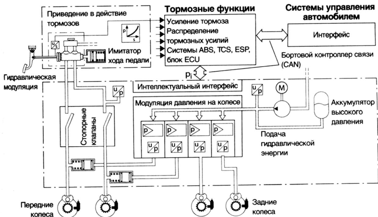
Рисунок 7.3 - Схема электрогидравлической тормозной системы (ЕНВ)
