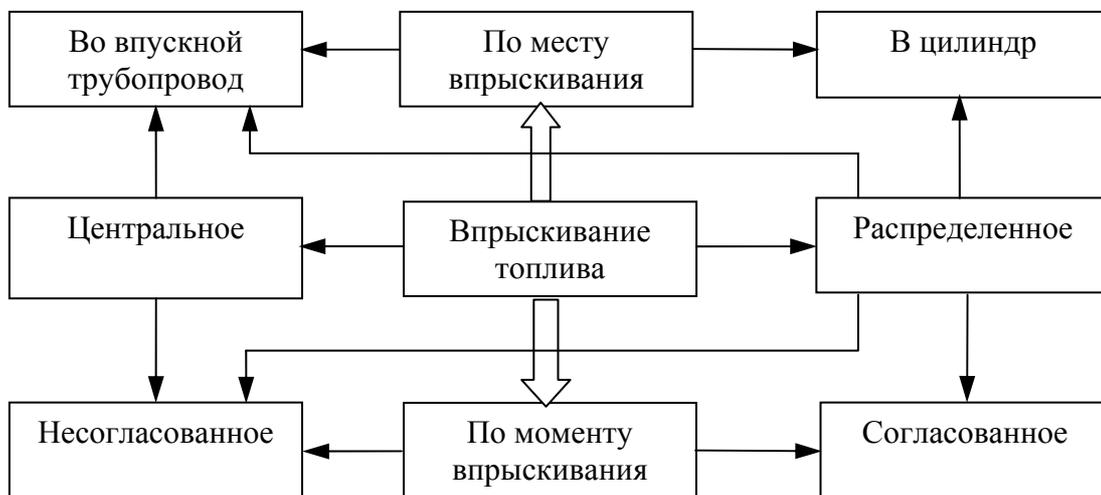
Рисунок 4.2 - Классификация способов впрыскивания топлива
