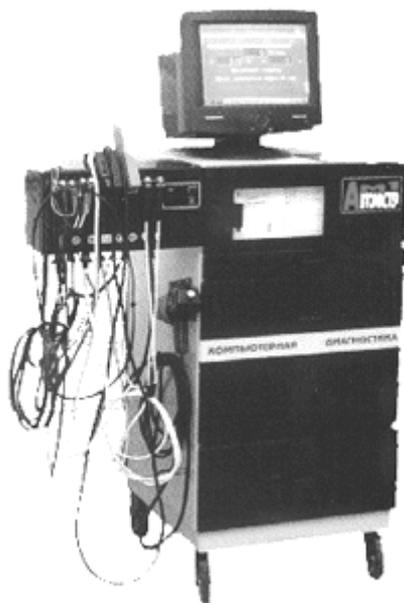
Рисунок 12.2 - компьютерный мотор-тестер «Автомастер АМ1»
