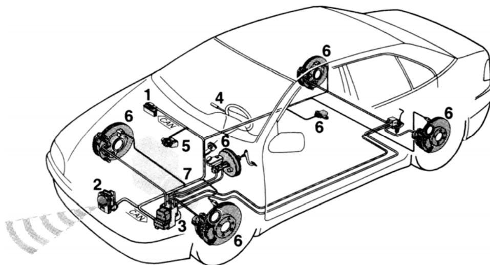
1 - ECU управления работой двигателя; 2 - блок проверки работы радиолокационного датчика; 3 - блок управления работой тормозов при включении круиз-контроля; 4 - контрольные приборы и блок индикации; 5 - блок управления двигателем при включении круиз-контроля; 6 - датчики; 7 - блок управления трансмиссией при включении круиз-контроля
