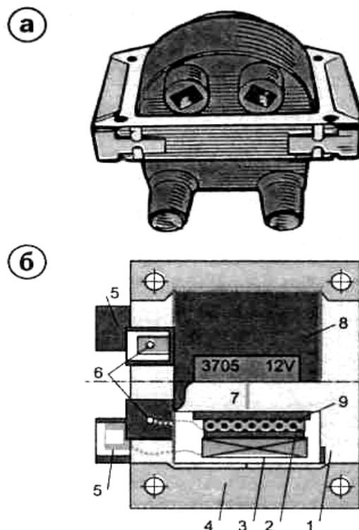
*а – внешний вид; б – катушка в разрезе; 1 – замкнутый магнитопровод с воздушным зазором; 2 – первичная обмотка; 3 – корпус; 4 – вторичная обмотка; 5- высоковольтные выводы; 6 – низковольтные выводы. 7 – воздушный зазор; 8 – заливка полипропиленом; 9 – пластмассовый каркас.*
