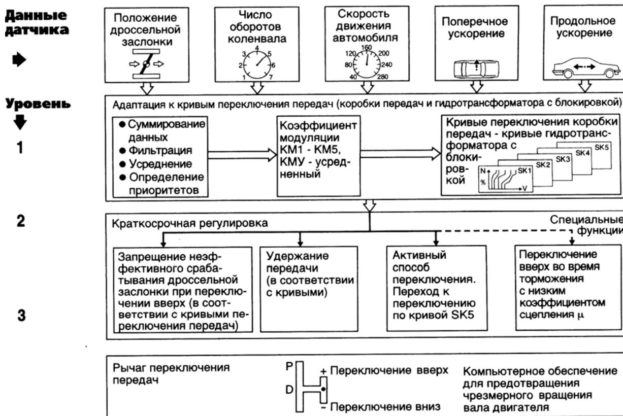
Рисунок 5.1 – Архитектура управления АКП на базе гидротрансформатора [1]
