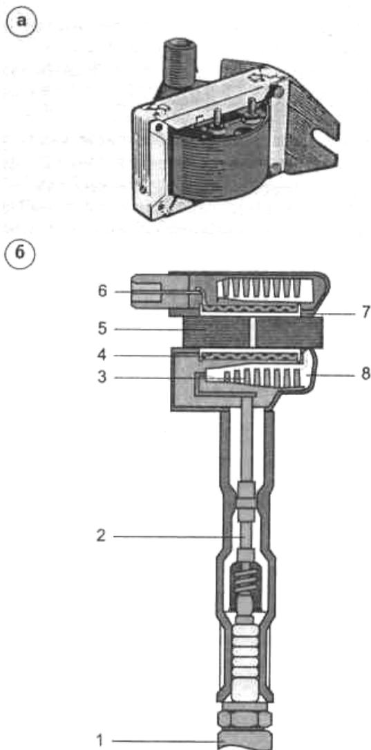
*а – отечественного производства с накоплением в индуктивности; б- катушка фирмы BOSH с индуктивным накопителем; 1- свеча зажигания; 2 – высоковольтный провод; 3 - многосекционная вторичная обмотка; 4 – первичная обмотка; 5 – сердечник; 6 – низковольтный вывод; 7 - заливка полипропиленом; 8 – пластмассовый корпус.*
