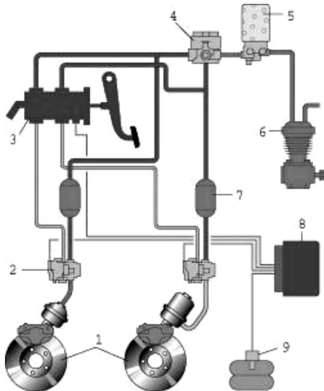
*1 - колесные тормозные механизмы; 2 - модуль регулирования давления; 3 - педаль тормоза с блоком включения и датчиком хода педали; 4 - защитный клапан; 5 - осушитель воздуха; 6 - компрессор; 7 - ресивер; 8 - блок управления; 9 - датчик нагрузки; 10 - гидравлический модуль с электронным управлением; 11 - датчик положения автомобиля; 12 - аккумуляторные батареи.*
