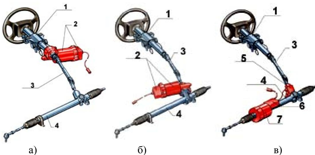
1 - рулевая колонка; 2- электроусилитель с червячной передачей и электронным блоком управления; 3- промежуточный вал; 4- реечный рулевой механизм; 5 - следящее устройство с торсионом; 6 - блок управления; 7- электропривод с механизмом винт-шариковая гайка-рейка
