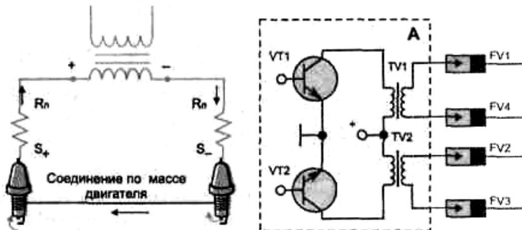
Рисунок 3.5 – Соединение свечей зажигания с двухвыводной катушкой
