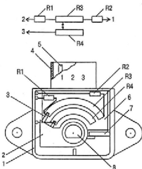
1 - корпус, 2 - поворотная втулка, 3 - подвижной контакт, 4 - штекерная колодка, 5 - штекер; 6 - печатная плата, 7- упор, 8 - ось дроссельной заслонки, R1, R2, R3 и R4 – сопротивления
