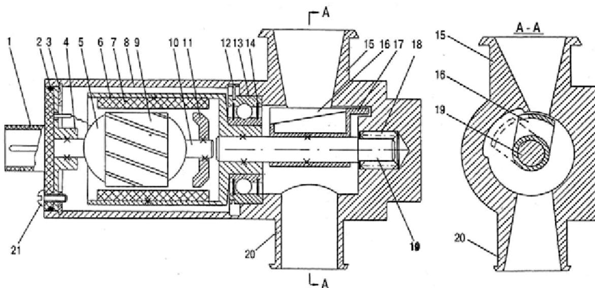
1 - штекерная колодка, 2 - уплотнительное кольцо, 3 - шайба крепления, 4 - фланец крепления оси якоря, 5 - обмотка якоря, 6 - поворотный стакан, 7 - магнит, 8 - корпус; 9 - якорь неподвижный, 10 - ось якоря, 11 - магнитопровод, 12 - стопорное кольцо подшипника, 13 - шариковый подшипник, 14 - уплотнение подшипника, 15 - патрубок входной, 16 - поворотная заслонка, 17 - упор, 18 - роликовый подшипник, 19 - вал заслонки, 20 - патрубок выходной, X-соединение неразъемное
