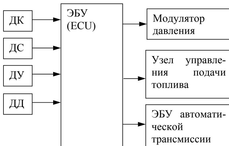
*ДК – датчики колес; ДС- датчик скорости; ДУ – датчик ускорения; ДД - датчик положения дросселя*
