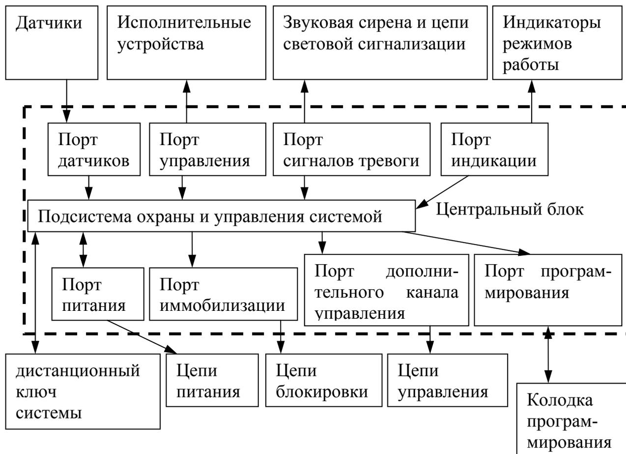
Рисунок 11.1 – Структурная схема автосигнализации модульного типа
