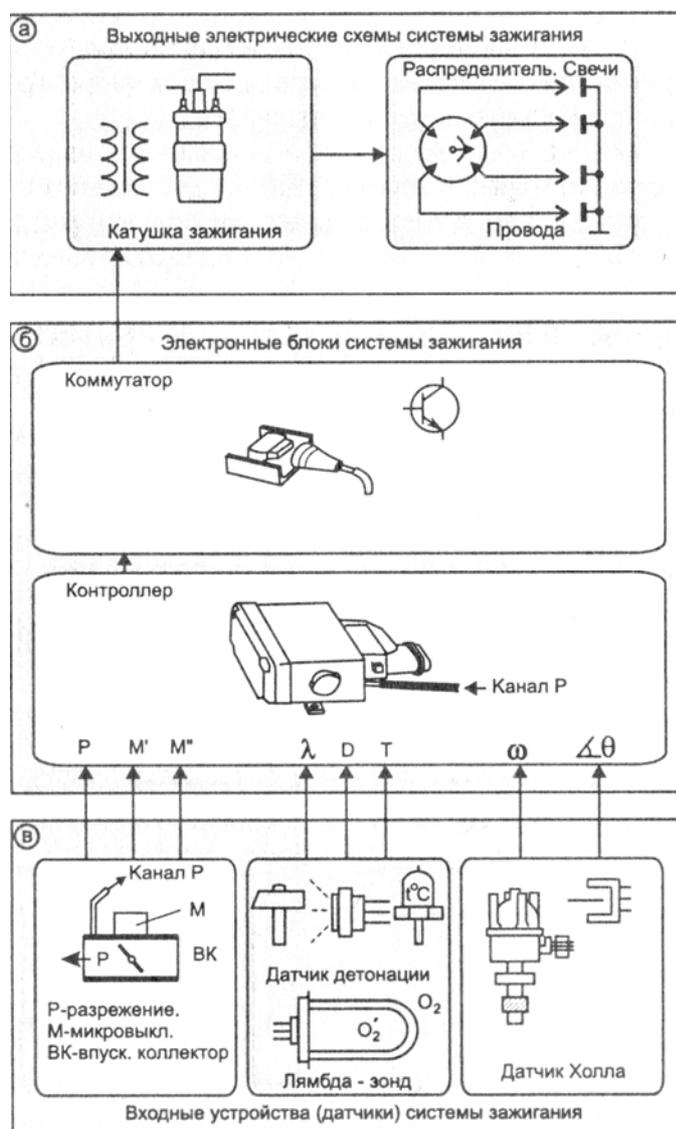
а - выходные электрические схемы; б - электронные блоки; в – входные устройства (датчики); P, M', M'' – сигналы от датчиков дроссельной заслонки; λ, D, T – сигналы от датчиков кислорода, детонации и температуры двигателя; ω, P, θ - сигналы от датчика Холла.
