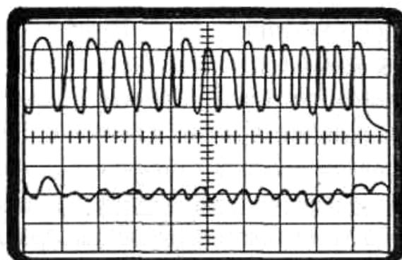
Рисунок 12.4 – Осциллограммы датчиков кислорода каталитического нейтрализатора: вверху входной датчик, снизу – на выходе нейтрализатора [22]
