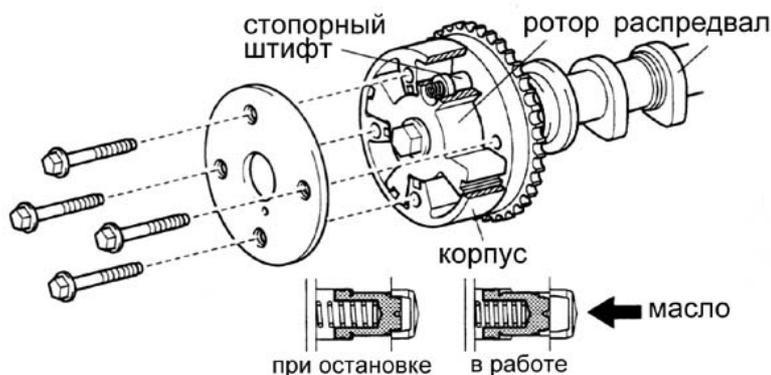
Рисунок 4.22- Исполнительный механизм системы VVT-i (Toyota) [29]
