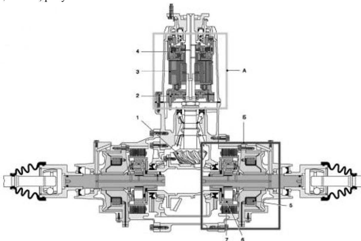
1 – гипоидная передача; 2 – гидравлический привод; 3 – планетарная передача; 4 – сцепление; 5 – соленоид; 6 – планетарная передача; 7 – сцепление; А – ускорительный модуль; Б – блок электромагнитного сцепления
