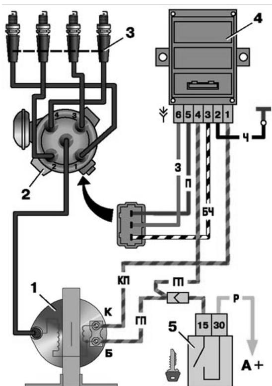
1 – катушка зажигания; 2 – датчик-распределитель зажигания; 3 – свечи зажигания; 4 – коммутатор; 5 – выключатель зажигания; А – к источникам питания.
