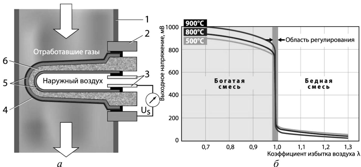
1 – труба выпускной системы; 2 – корпус датчика; 3 – контактные площадки; 4 – керамический защитный слой; 5 – внешний и внутренний электроды; 6 – керамическая основа ( $ZrO_2$  и  $Y_2O_3$ ).  $U_s$  – выходное напряжение.
