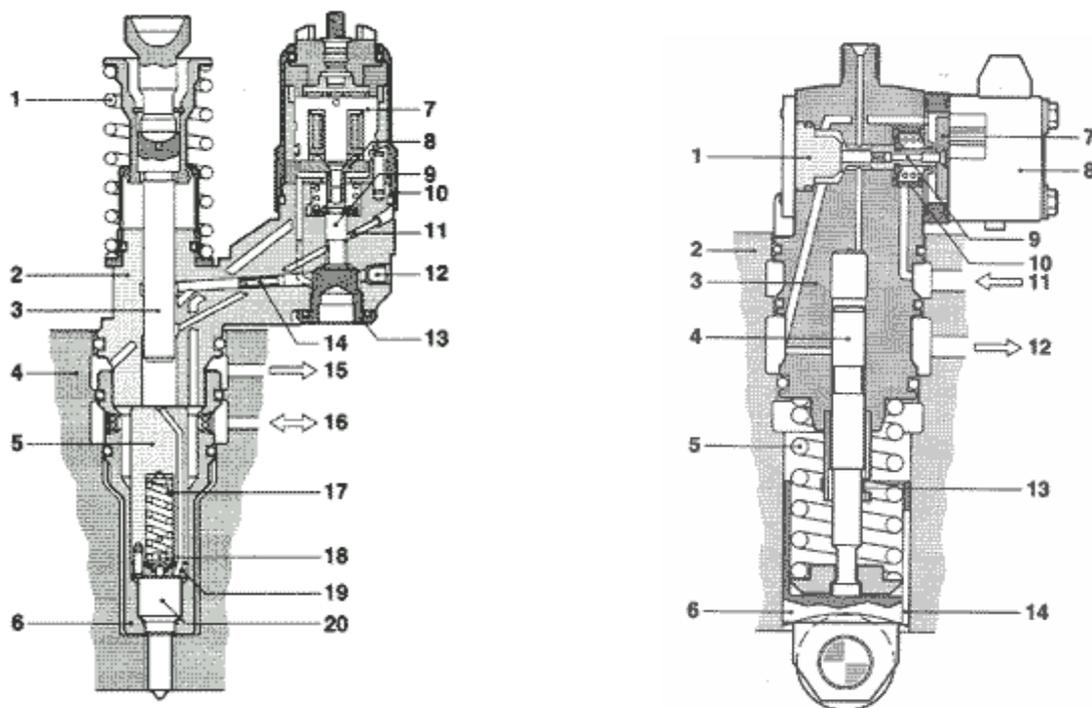
1 - пружина; 2 - корпус насоса; 3 - плунжер насоса; 4 - головка цилиндра; 5 - держатель пружины; 6 - стяжная гайка; 7 - статор; 8 - якорная пластина; 9 - игла соленоидного клапана; 10- стяжная гайка соленоидного клапана; 11 - заглушка канала высокого давления; 12 - заглушка канала низкого давления; 13 - упор иглы солеоида; 14 - сужение; 15 - возврат топлива; 16 - подача топлива; 17 - инжектор; 18 - нажимной штифт; 19 - прокладка; 20 - распылитель
