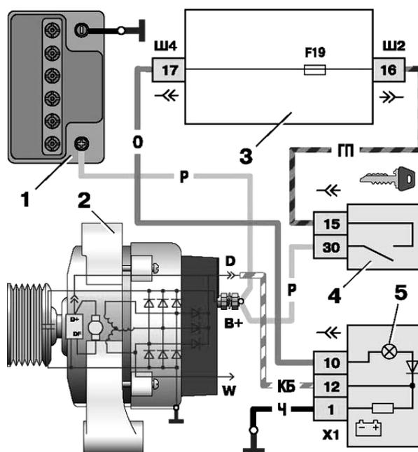
1 – аккумуляторная батарея; 2 – генератор; 3 – монтажный блок; 4 – выключатель зажигания; 5 – контрольная лампа заряда аккумуляторной батареи, расположенная в комбинации приборов
