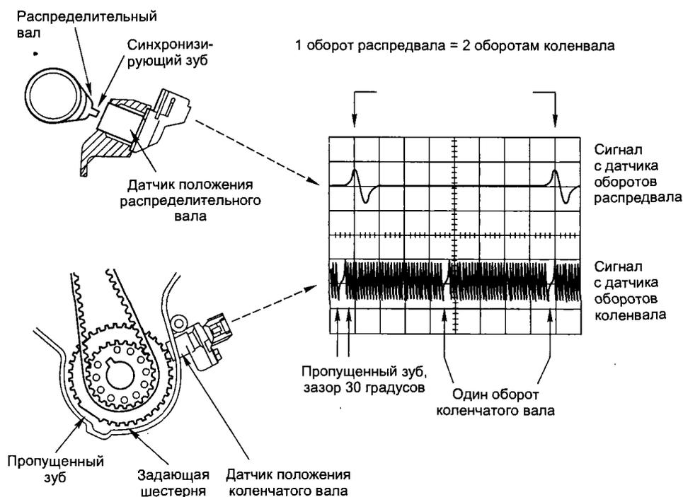
Рисунок 12.6 - Схема работы монитора пропусков в системе зажигания [26]
