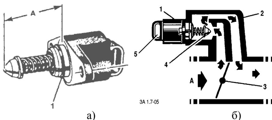
1- шаговый двигатель регулятора холостого хода; 2- дроссельный патрубок; 3- дроссельная заслонка; 4- запорная игла клапана PXX; 5- электрический разъем; А- поступающий воздух.
