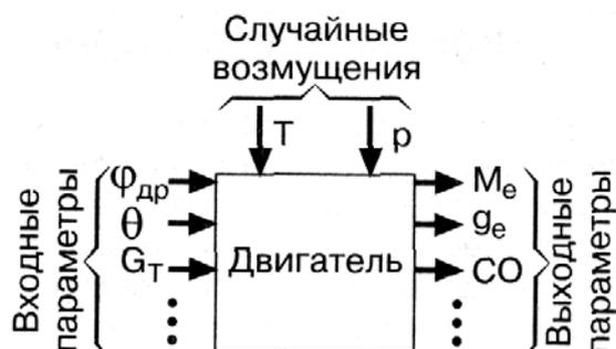
Рисунок 4.1 – Схема двигателя как объекта автоматического управления
