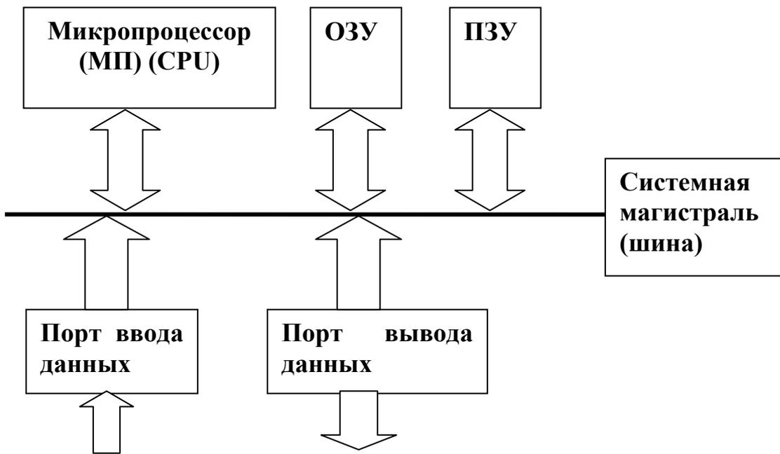
Рисунок 1.1 -Структурная схема микропроцессорной системы
