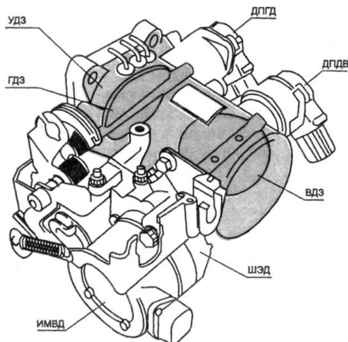
*УДЗ – узел дроссельных заслонок; ГДЗ – главная дроссельная заслонка; ИМВД – исполнительный механизм вспомогательной дроссельной заслонки; ДПГД – датчик положения главной дроссельной заслонки; ДПВД – датчик положения вспомогательной дроссельной заслонки; ВДЗ – вспомогательная дроссельная заслонка*
