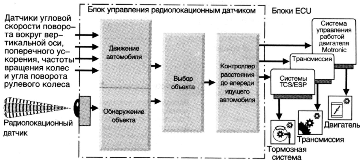
Рисунок 10.11 – Схема управления адаптивного круиз-контроля [1]
