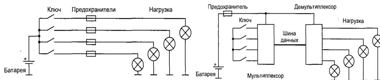
Рисунок 2.2 - Обычное и мультиплексное подключение нагрузок [19]
