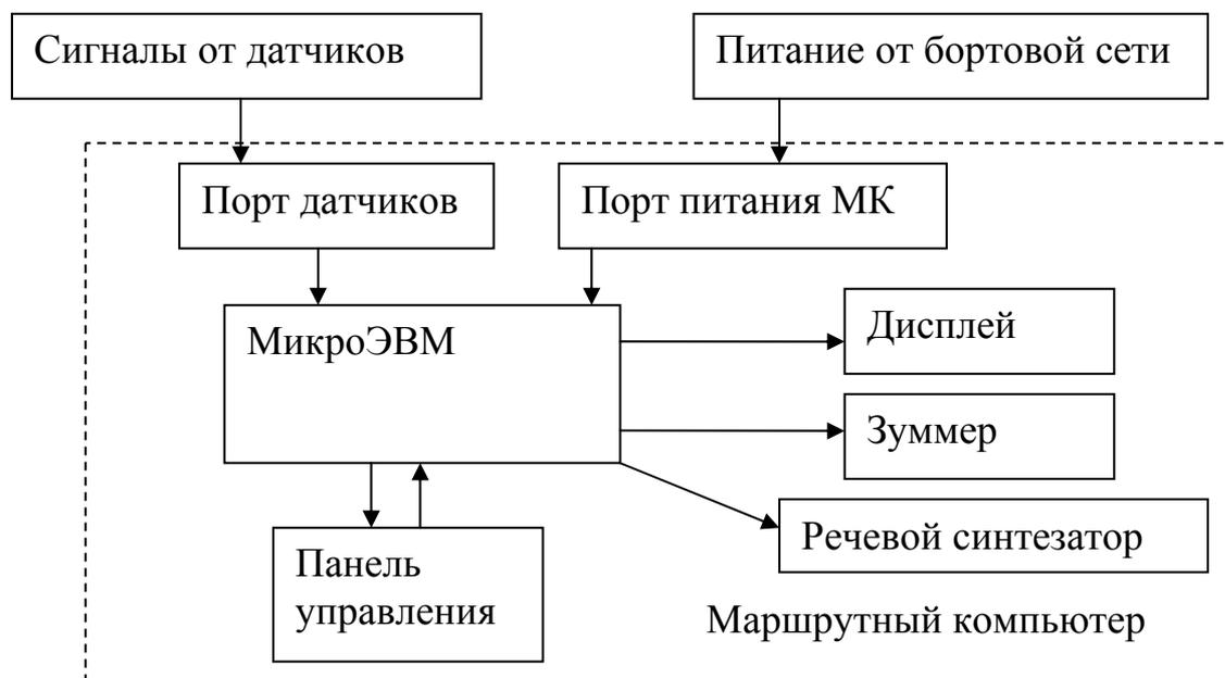
Рисунок 10.9 - Структурная схема автомобильного маршрутного компьютера
