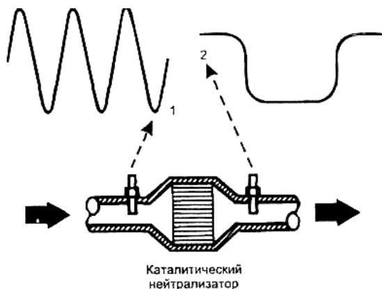
Рисунок 12.3 – Датчики кислорода каталитического нейтрализатора и их сигналы [22]
