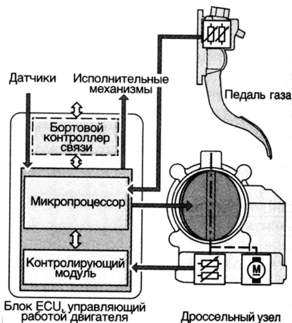
Рисунок 4.4 - Система с электронным управлением дроссельной заслонкой (ETC, ETCS) [1]
