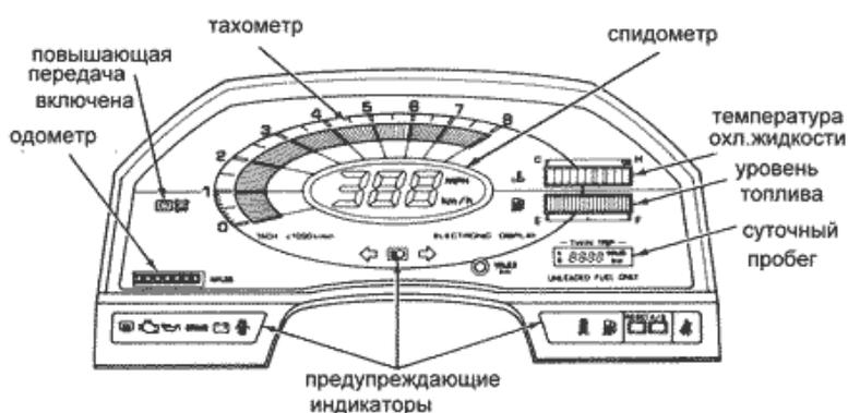
Рисунок 10.3 - Жидкокристаллический дисплей одной из моделей Toyota
