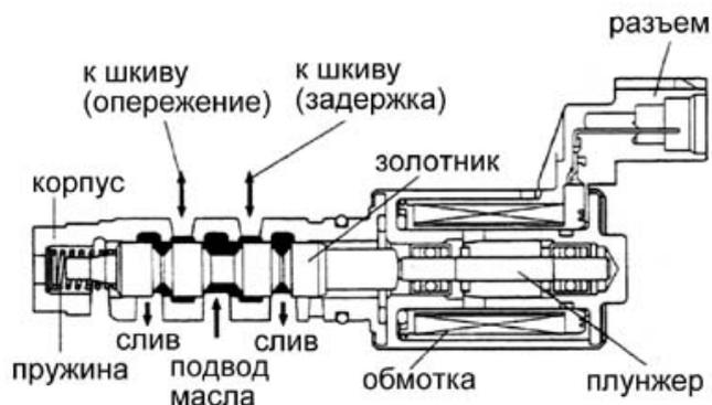
Рисунок 4.23 – Клапан OCV (Oil Control Valve) системы VVT-i [29]
