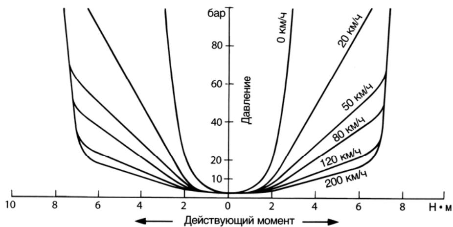
Рисунок 6.2 – Закономерности работы усилителя рулевого управления [1]
