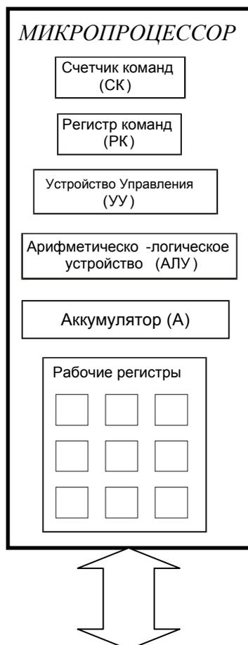
Рисунок 1.2 – Структурная схема микропроцессора
