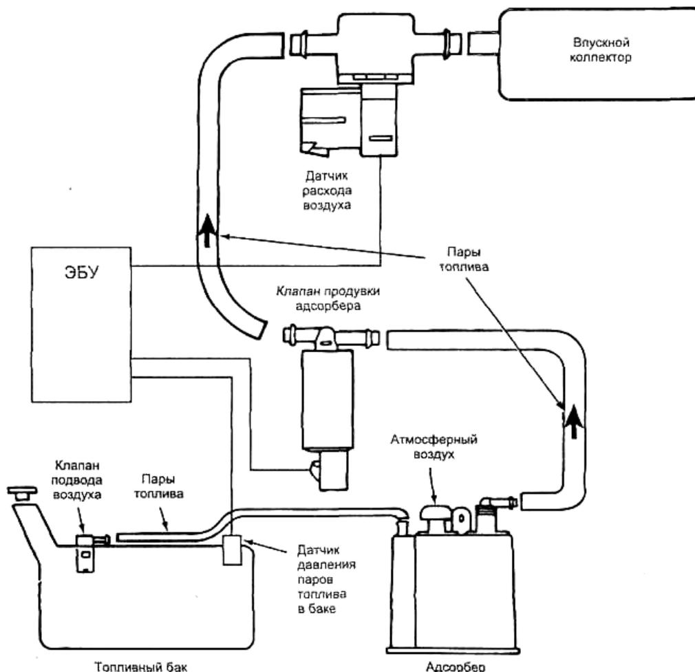
Рисунок 12.8 – Схема системы улавливания паров бензина [26]
