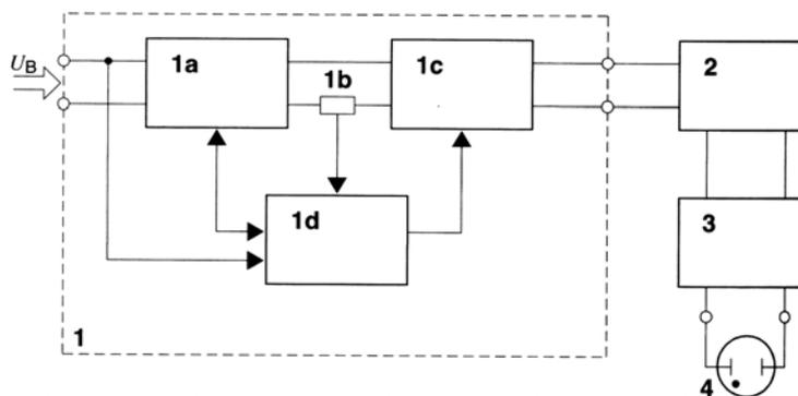
1 - блок ECU (1a - преобразователь постоянного напряжения; 1б - шунт; 1с- преобразователь постоянного тока в переменный; 1d- микропроцессор); 2 - элемент зажигания; 3 - панель лампы; 4 - лампа D2S;  $U_B$  - напряжение аккумулятора
