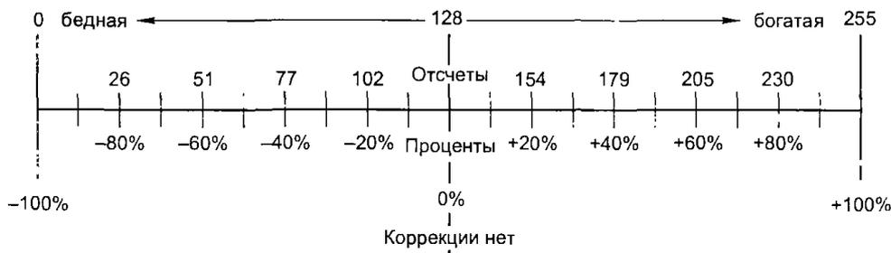
Рисунок 12.7- Шкала коэффициентов топливокоррекции [26]
