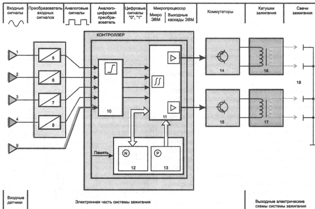
1-4 – входные датчики неэлектрических воздействий (акцепторы); 5-8 - преобразователи неэлектрических величин в аналоговые электрические сигналы; 9 - датчик абсолютного давления (MAP); 10 – АЦП; 11 - интегральная схема микропроцессора; 12 – оперативная “N”; 13 – постоянная “P” память ЭБУ; 14, 15 - коммутаторы; 16, 17 – двухвыводные катушки зажигания; 18 – свечи зажигания.
