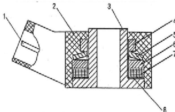
1 - штекер, 2 - изолятор, 3 - корпус, 4 - гайка, 5- упругая шайба; 6 - инерционная шайба, 7 - пьезоэлемент, 8- контактная пластина
