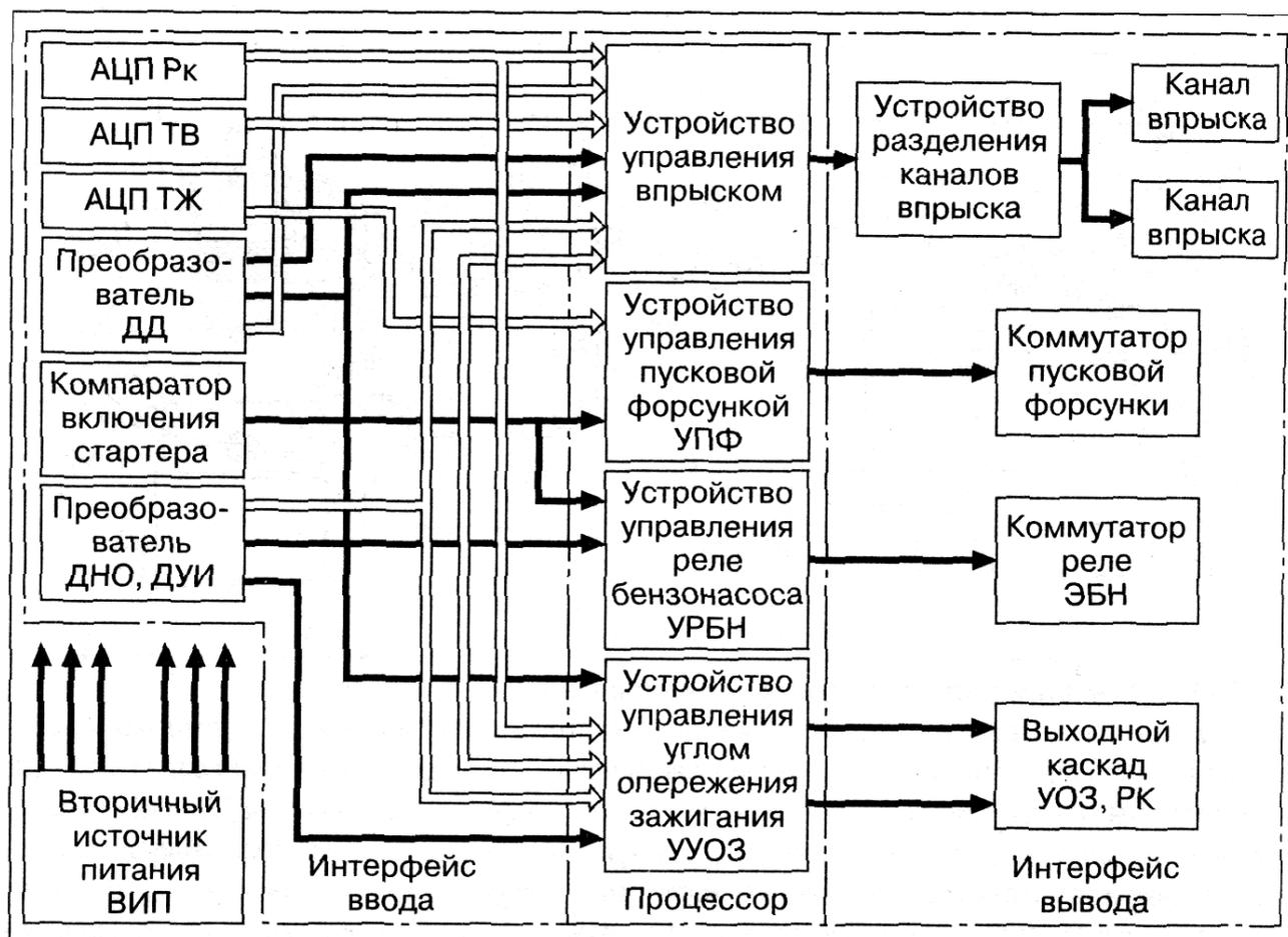
Рисунок 4.13 - Блок-схема электронного блока управления [23]
