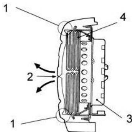
*1- ось поворота крышки; 2- линия слома; 3 – газогенератор; 4- воздушный мешок.*
