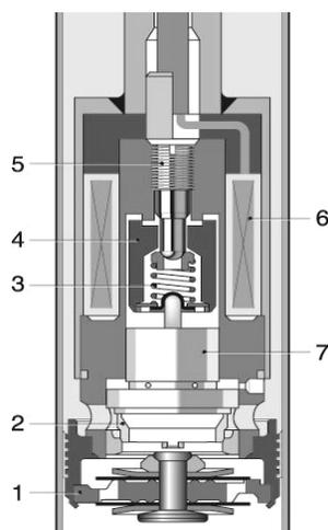
1 - дополнительный клапан; 2 - подвижное уплотнительное кольцо; 3 - пружина главного демпфирующего клапана; 4 - якорь; 5 - винт; 6 - магнитная катушка; 7 - главный демпфирующий клапан.
