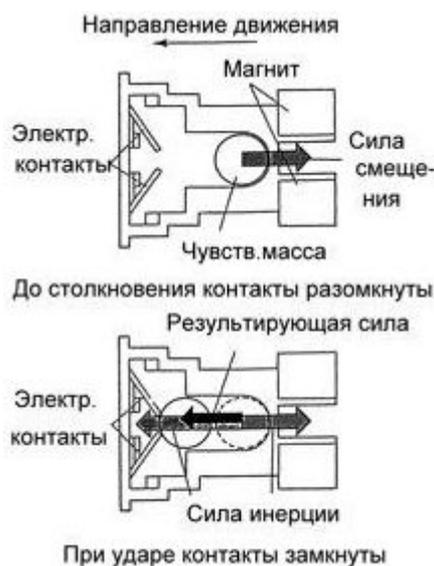
Рисунок 8.3 - Датчик удара с постоянным магнитом [26]
