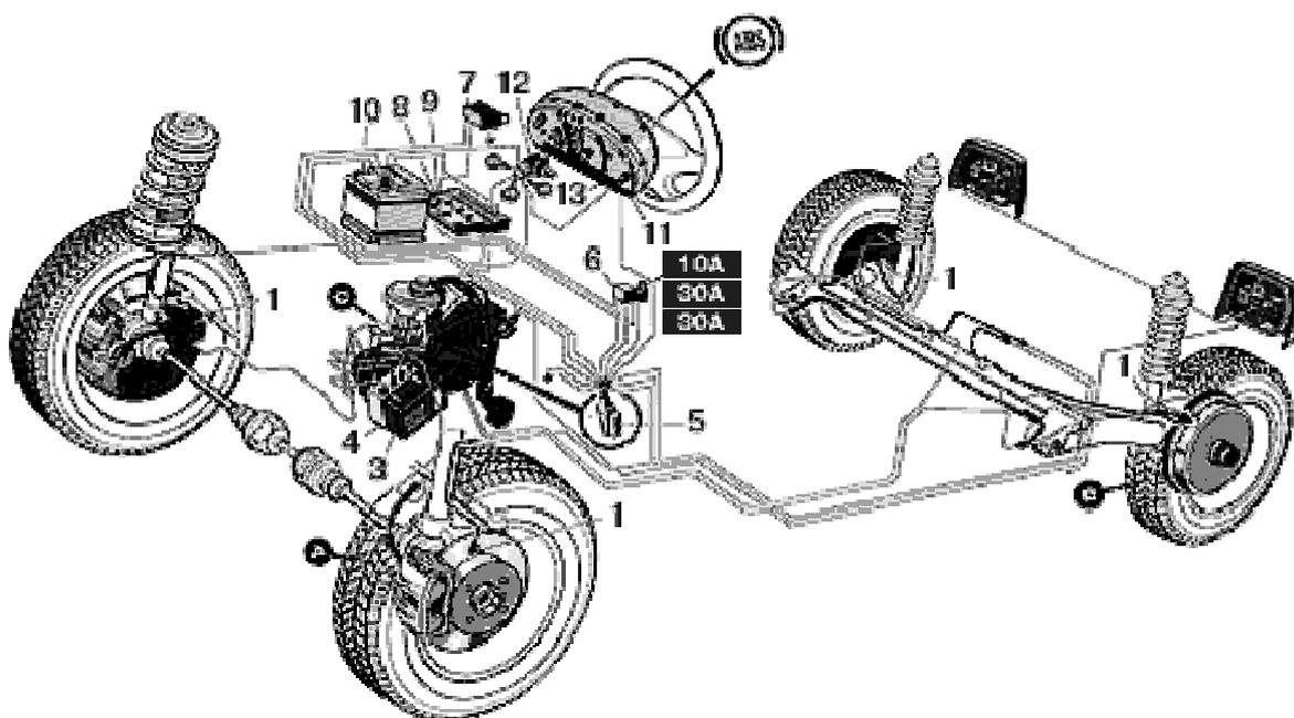
1 - датчик угловой скорости; 2 - вращающийся элемент с прорезями и выступами; 3 - электронный блок управления; 4 - модулятор; монтажный разъем; 6 - предохранители; 7 - диагностический разъем; 8 - переключатель; 9 - блок предохранителей; 10 - аккумулятор; 11 - панель приборов; 12 - выключатель ABS; 13 - индикатор ABS
