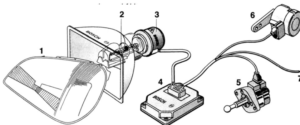
1 - линза со светорассеивающей оптикой; 2 - газоразрядная лампа; 3 - блок включения; 4 - блок ECU; 5 - шаговый электродвигатель; 6 - датчик угла поворота вокруг оси; 7 - к бортовой системе электрооборудования автомобиля
