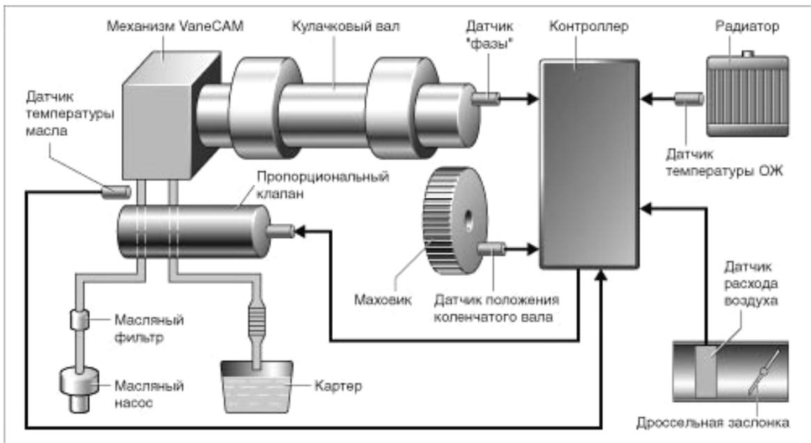
Рисунок 4.24 – Схема системы управления фазами газораспределения VANOS [27]
