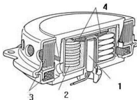
*1- зажигающее устройство; 2- горючее вещество; 3- фильтр и теплопоглотитель, 4- вещество, ускоряющее горение*
