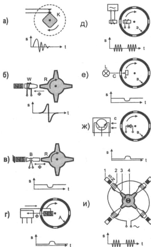
Рисунок 3.2 - Разновидности бесконтактных датчиков для БТСЗ
