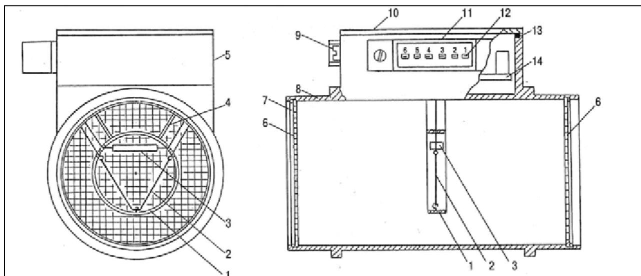
1 - кольца, 2 - платиновая нить, 3 - термокомпенсационное сопротивление, 4 - кронштейн крепления кольца, 5 - корпус электронного модуля, 6 - предохранительная сетка, 7 - стопорное кольцо, 8 - корпус датчика, 9 - винт регулировки СО, 10 - крышка, 11 - колодка электрического разъема, 12 - штекер, 13 - уплотнитель, 14 - электронный модуль
