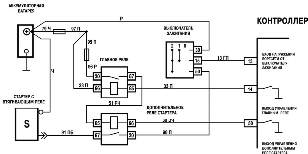
Рисунок 2.5 – Схема электронной блокировки включения стартера ВАЗ-2111 [18]
