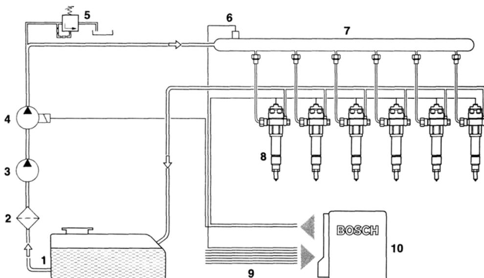
1 - топливный бак; 2 - фильтр; 3 - топливоподкачивающий насос; 4 - насос высокого давления; 5 - редукционный клапан; 6 - датчик давления; 7 - аккумулятор; 8 - форсунки; 9 - ввод данных от измерительных датчиков; 10 - ЭБУ
