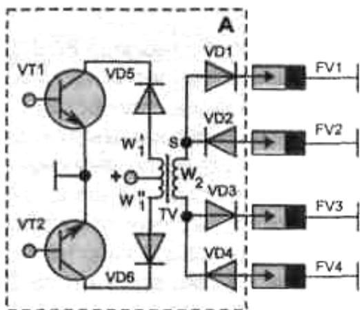
*A – выходной каскад; VD1-VD4 – высоковольтные диоды; TV – трансформатор зажигания*
