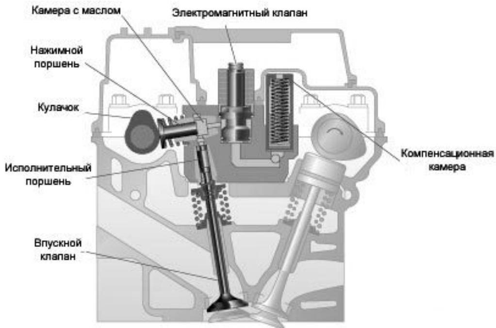
Рисунок 4.25 – Система VVA (Variable Valve Actuation), фирма ФИАТ [27]
