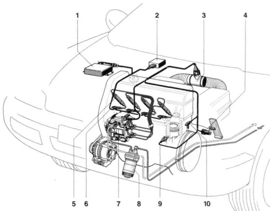
1 - ЭБУ двигателя; 2 - блок управления работой свечами накаливания; 3 - датчик массового расхода воздуха; 4 - датчик положения педали газа; 5 - форсунка; 6 - свеча накаливания; 7 - роторный ТНВД распределительного типа с блоком ЭБУ; 8 - топливный фильтр; 9 - датчик температуры; 10 - датчик частоты вращения коленчатого вала
