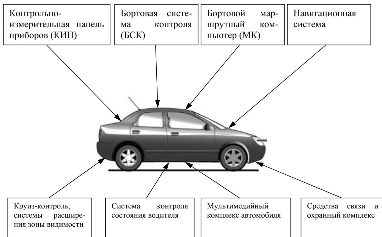
Рисунок 10.1 – Блок-схема информационной системы автомобиля
