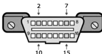
Рисунок 12.10 – Диагностический разъем по стандарту OBD-II
