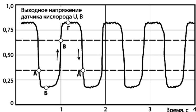
Рисунок 12.5 – Сигнал исправного датчика кислорода на входе нейтрализатор [27]
