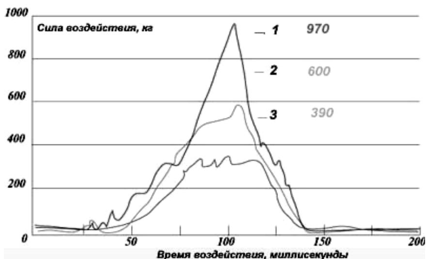
1- Обычные ремни и подушка; 2- обычная подушка и ремни с ограничителем нагрузки (система PRS I); 3 - новая подушка и ремни с ограничителем нагрузки (система PRS II)
