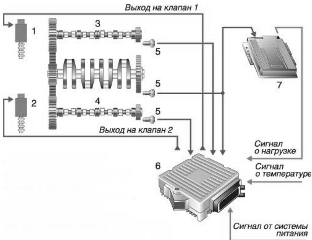
1 - клапан управления фазами на впуске; 2 - клапан управления фазами на выпуске; 3 - кулачковый вал впускных клапанов; 4 - кулачковый вал выпускных клапанов; 5 - датчики положения валов двигателя; 6 - контроллер VStronic; 7 - контроллер двигателя.
