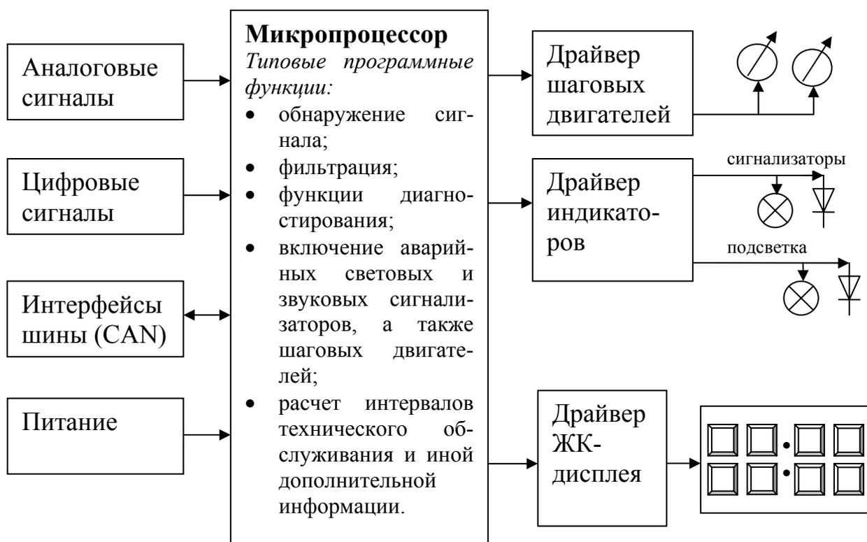
Рисунок 10.4 - Блок-схема электронной приборной панели с применением микропроцессора
